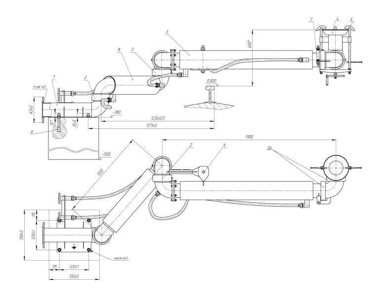
Рисунок 1 — Установка для нижнего слива нефти и нефтепродуктов из железнодорожных вагонов-цистерн УСН-150 ХЛ 1 ПП
