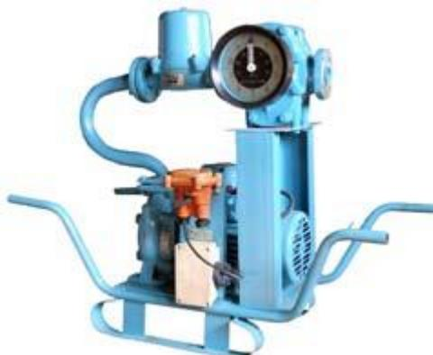
Установка УПН-40 предназначена для перекачивания и учета нефтепродуктов (светлых). А также выполнения других технологических операций на нефтебазах и АЗС. Установка является переносной и выполнена во взрывозащищенном исполнении. Подсоединение к патрубку насоса - шланговое, к счетчику - фланцевое.
