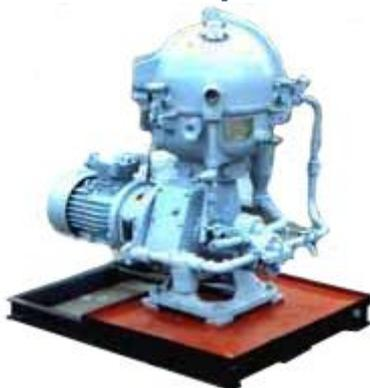
**Предназначен для очистки от механических примесей и отделения от воды дизельных топлив, а также смазочных и энергетических масел при вязкости не более 70 сСт ( при температуре +50 °С )**
