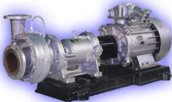
Насосы типа "НК" - центробежные, горизонтальные, консольные, одноступенчатые предназначены для перекачивания нефтепродуктов с плотностью до 1 т/м<sup>3</sup> и вязкостью до 0,01 см<sup>2</sup>/сек. Температура перекачиваемой жидкости от 273 до 353К (от 0 до 80°С) и от 273 до 473К (от 0 до +200°С).
