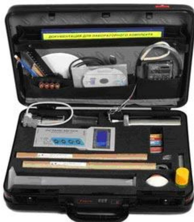
**Переносная лаборатория для отбора проб и оперативного проведения приемо-сдаточного анализа топлива
